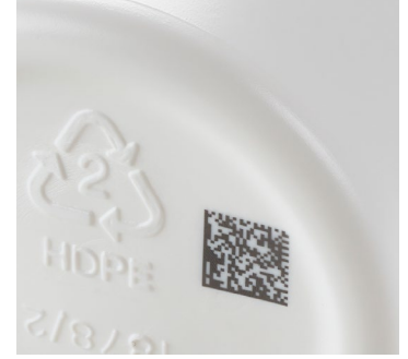
Videojet 7810 lazer sistemi, HDPE ambalajları üzerinde kalıcı, yüksek çözünürlüklü kodlar oluşturmak için Morötesi dalga boylarından yararlanmaktadır
